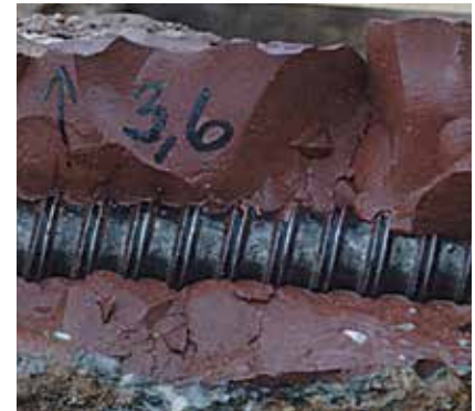
Aufgebrochener Verpresskörper TITAN 30/11 mit abgeschlossenem Rissbild.
