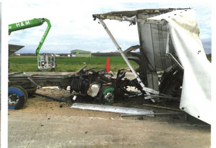
Bild 2: Crash-Test bestanden. Der Poller steht im völlig zerlegten Lkw
